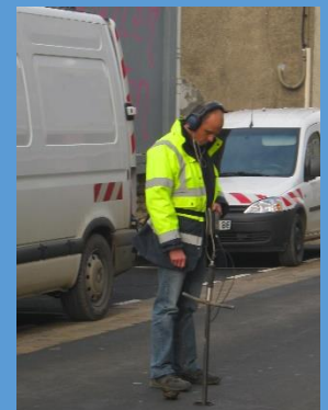
Recherche de fuites
