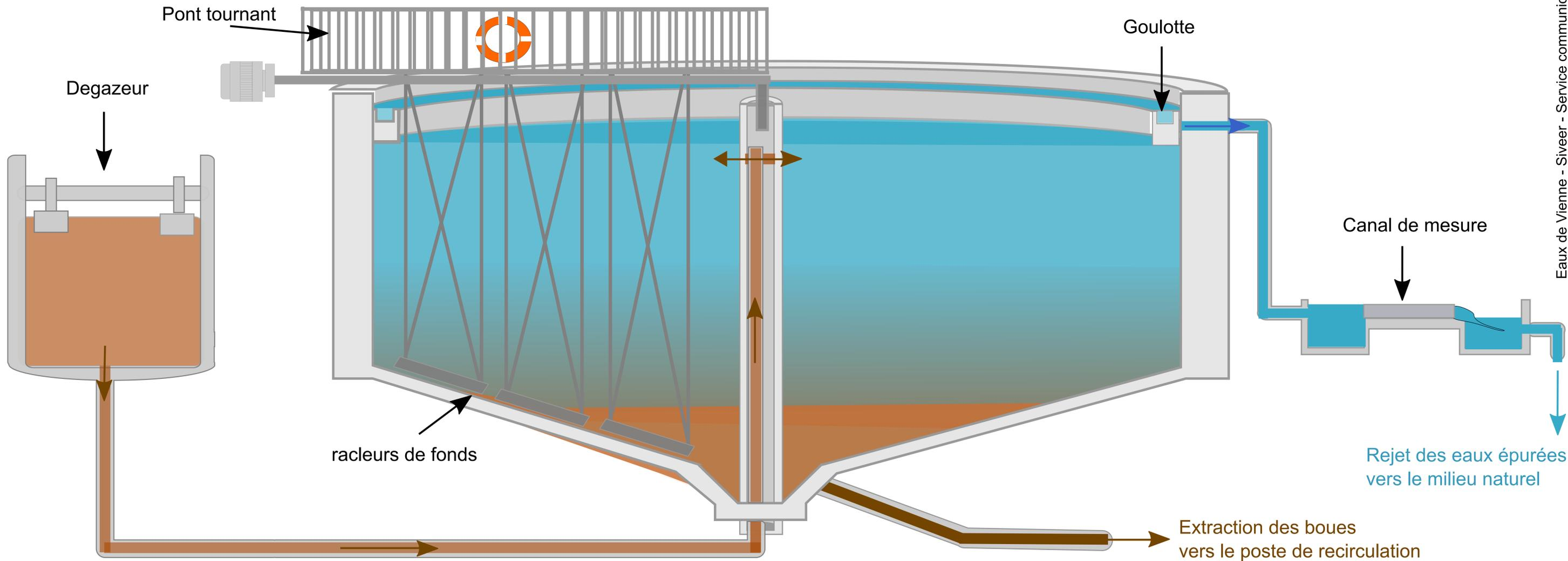
Après être passées dans le bassin d'aération, les eaux usées traversent le dégazeur pour être débarrassées de l'oxygène. Dans le bassin de clarification, appelé également décanteur, les boues se séparent de l'eau par décantation et se déposent au fond. Les boues sont extraites et dirigées vers le poste de recirculation. A la surface, l'eau épurée est évacuée par surverse pour être rejetée, ensuite, vers le milieu naturel.
