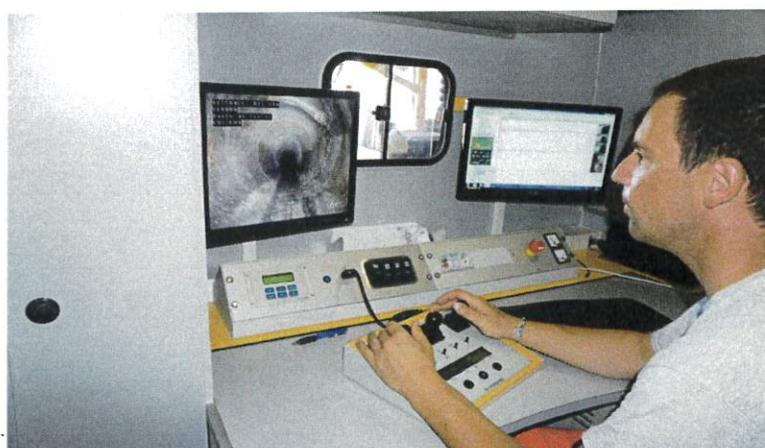
Contrôle caméra des réseaux d'assainissement collectif
